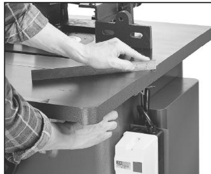
Рис. 10. Регулировка совмещения поверхностей
