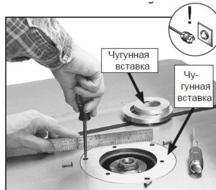
Рис. 8. Выравнивание вставки стола
