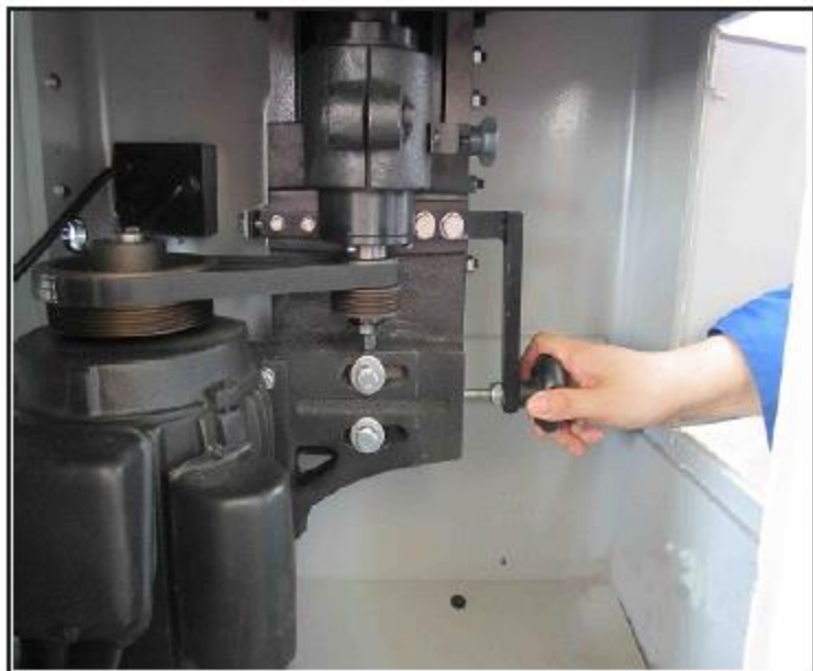
Рис. 14. Регулировка натяжения клинового ремня
