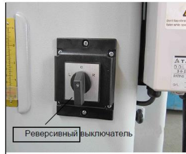
Рис. 13. Переключатель прямого и обратного вращения шпинделя
