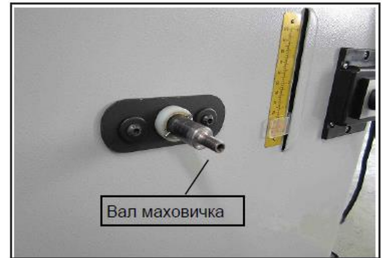
Рис. 3. Расположение вала маховичка
