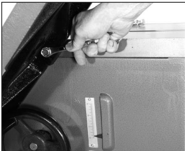
Рис. 9. Установка удлинительной консоли
