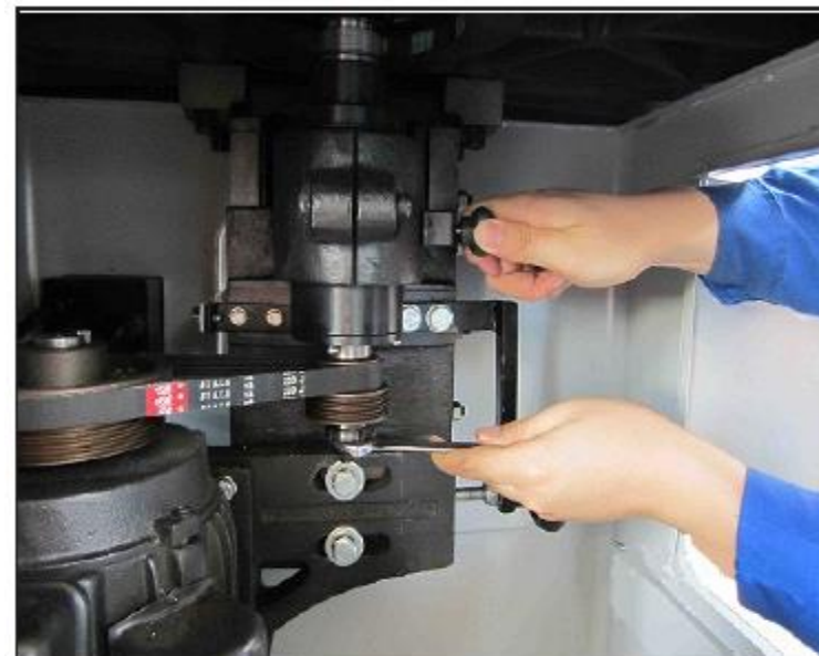
Рис. 7. Затяжка и ослабление шпинделя
