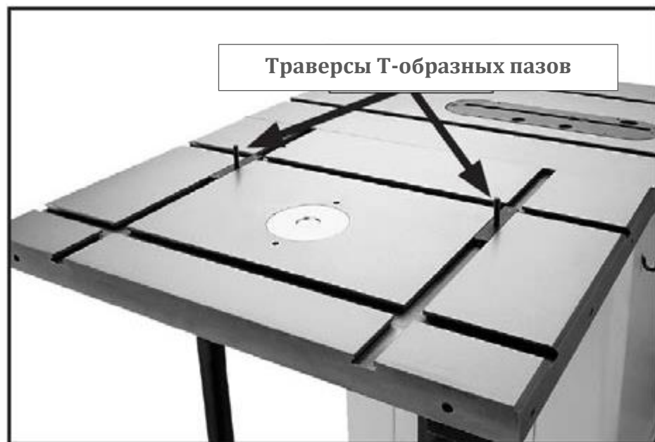
Рис. 6. Установленные траверсы Т-образных пазов
