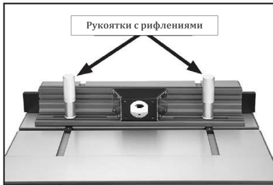
Рис. 7. Закреплённые рукоятки с рифлениями
