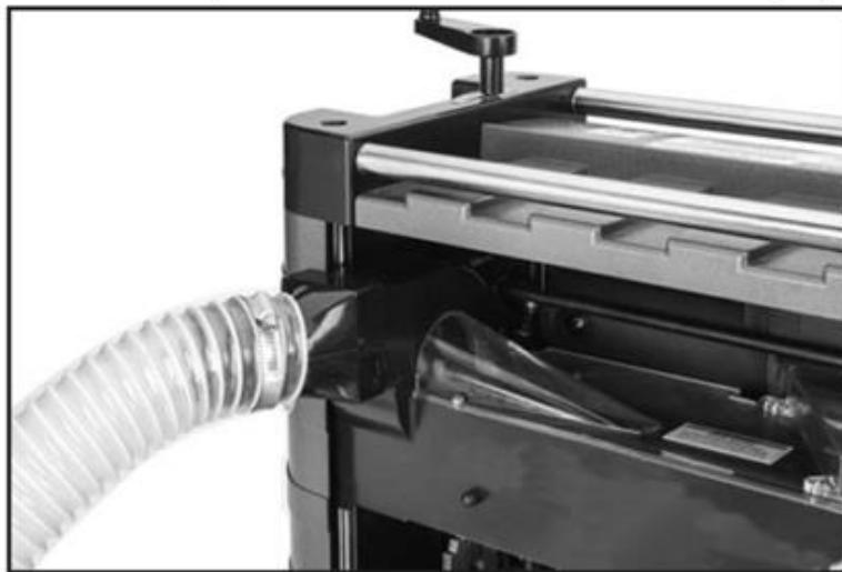
Рис. 12. Пылевой шланг, установленный на патрубок аспирации.
