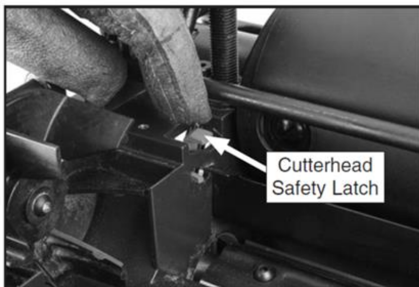
Рис. 22. Отсоединение фиксатора режущего вала.
