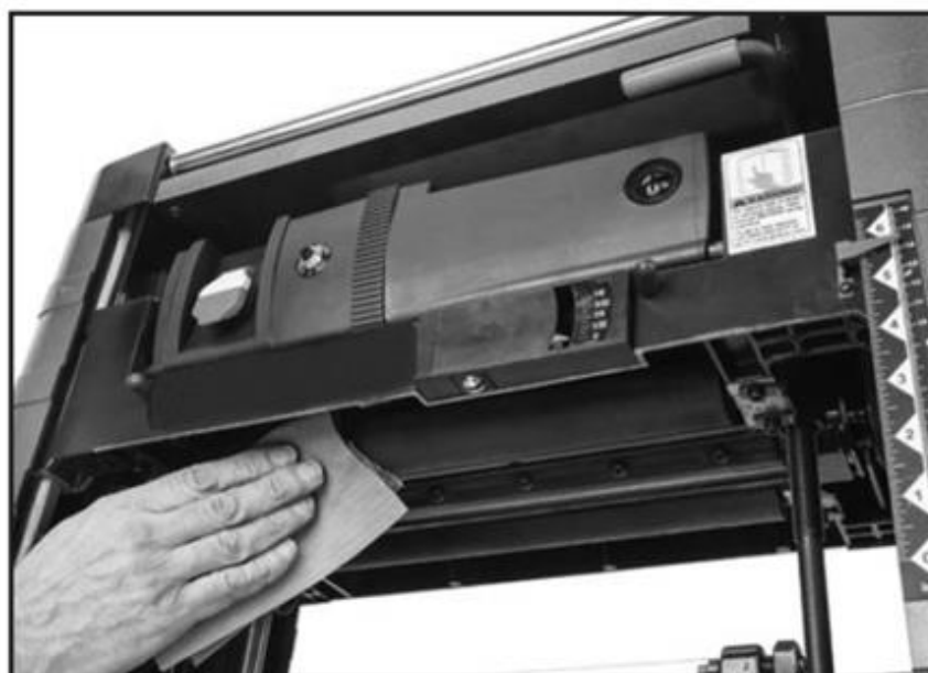
Рисунок 38. Очистка подающего ролика.
